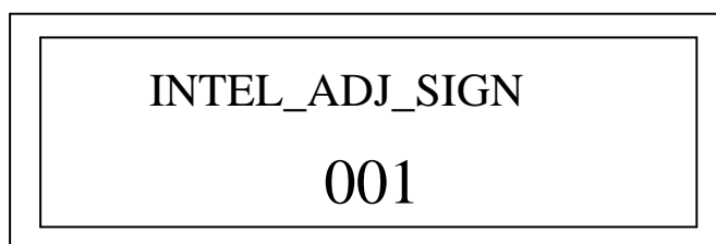
图二十：弧压智能调节功能是否有效设定
